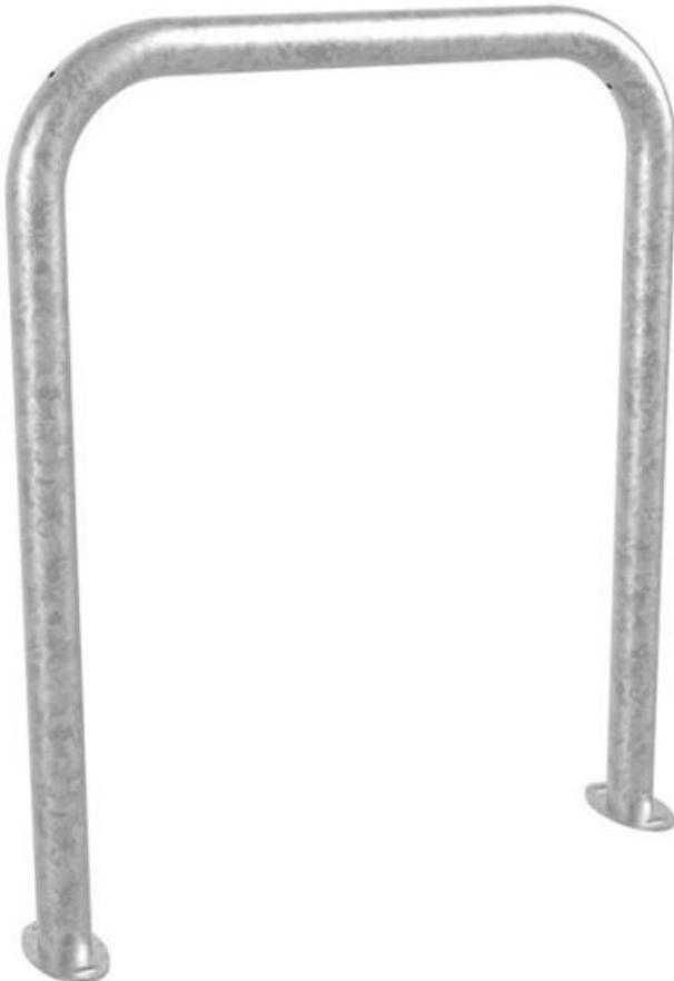
**Le support vélos U inversé** offre un service de sécurisation simple d'installation et d'utilisation pour le stationnement des vélos dans les espaces publics et les environnements extérieurs. Le modèle de base est à fixer au sol via les deux platines, mais il existe aussi en version rallongée de 18cm pour scellement direct dans le sol.
